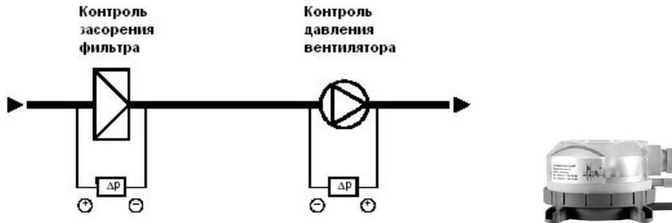
**Рисунок 4. Внешний вид и примеры использования датчиков давления.**
