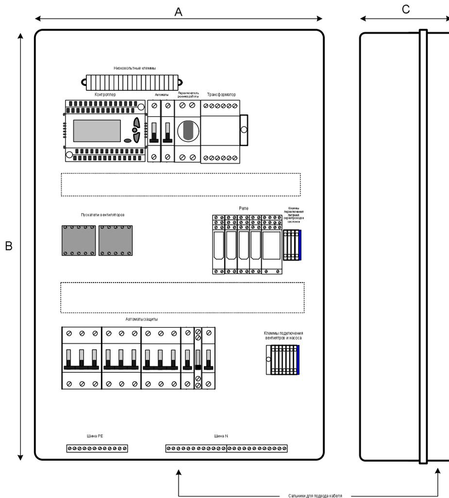
**Рисунок 6. Внешний вид блока при открытой крышке.**
